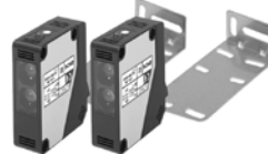
D – urządzenia wykrywające obecność człowieka lub przeszkody, znajdujących się na podłożu po jednej stronie bramy, np. fotokomórki. Uwaga! W przypadku zastosowania kombinacji C + D wymaga się aby urządzenie D było okresowo sprawdzane w odstępach nie większych niż 6 miesięcy.
